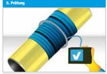
Nach dem Aufbringen des **DENSOLEN® Bandes** kann ein Hochspannungstest gemäß Norm durchgeführt werden. Es wird empfohlen Spiralelektroden oder Gummielektroden zu verwenden.
